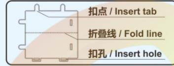
识别金属零件上的扣点、折叠线、扣孔的样子。
