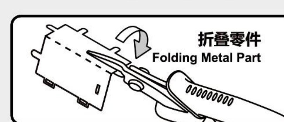
使用尖嘴钳,参照拼装说明书将金属零件折成形状。
