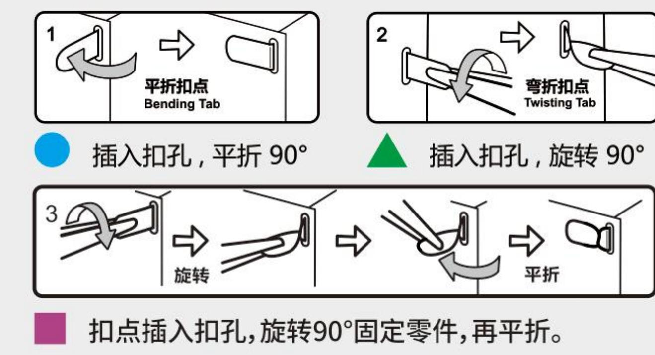
剪金属零件时请剪零件“水口位”,请勿将“扣点”当成“水口位”剪下,每次剪零件时请仅剪当前步骤的零件,切勿一次性将所有零件全部剪下,避免丢失;
