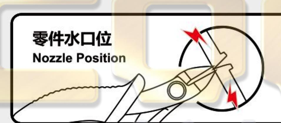
使用水口钳剪断金属零件上的水口,
